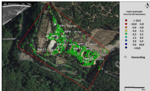
Monitoraggio in continuo delle deformazioni superficiali mediante Interferometria SAR Satellitare.
