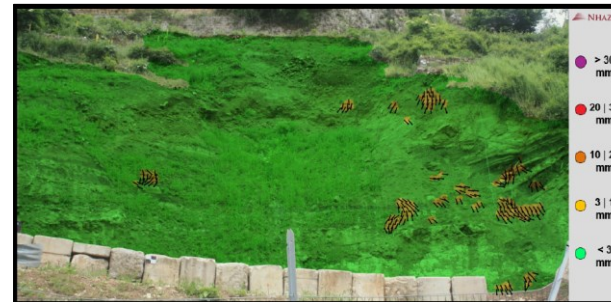
Monitoraggio conoscitivo tramite analisi multi-temporali di immagini ottiche (Photomonitoring™)
